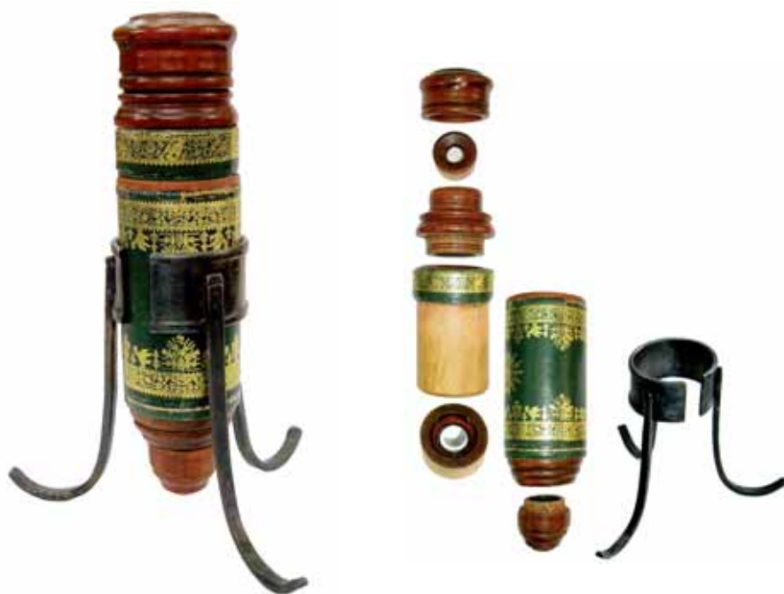
Cañón para ver las cosas pequeñas “occholino”, desarrollado por Galileo en 1609
